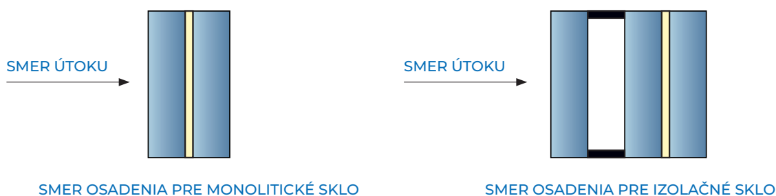
Obrázok 9 / Sklo odolné proti násilnému vniknutiu použité v izolačnom zasklení
