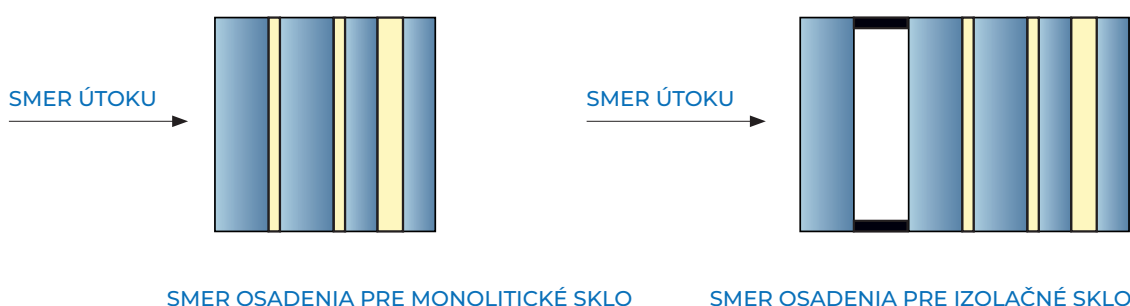
Obrázok 10 / Nepriestrelné sklo použité v izolačnom zasklení
