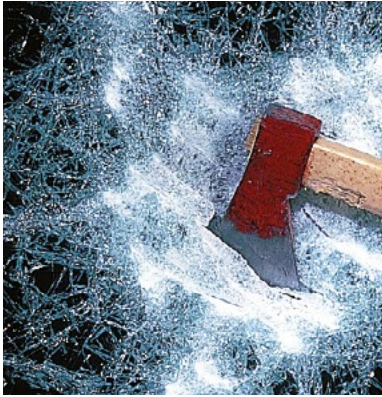
Hmotnost sekery: 2 kg Zkušební formát VSG: 900 x 1100 mm Provedení: Počet úderů pro otvor 400 x 400 mm
