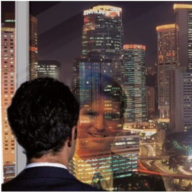
Jasný zrcadlový efekt u okna v noci. Normální vnitřní reflexe mezi 20 % a 30 %.
