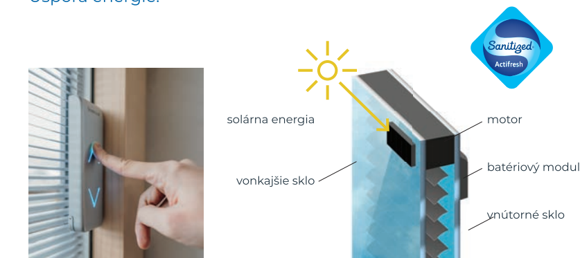
Ovládanie interným motorom so solárnym modulom a batériou
